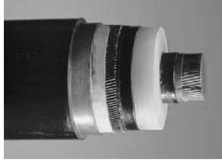
Abbildung 6.12. Beispiel eines Hochspannungskabels: Nennspannung 132 kV, Nennleistung 315 MVA, Kupferleiter mit Querschnitt 2000 \text{ mm}^2 , XLPE Isolierung (vernetztes Polyethylen), spez. Masse 40 kg/m. Quelle: ABB.
